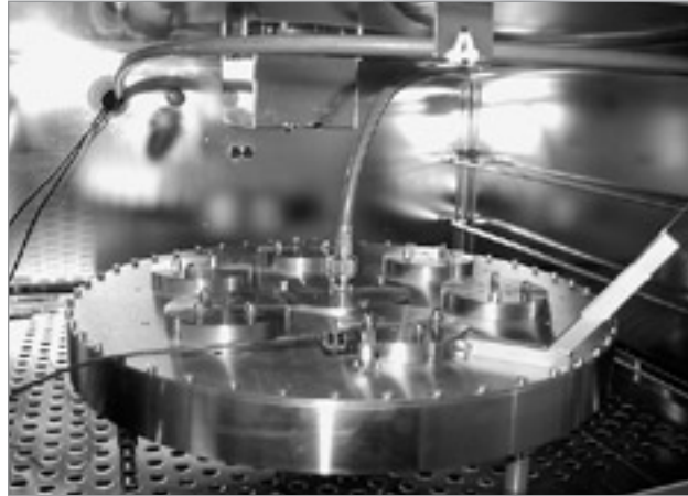
Abbildung 4: Radiale Hohlwellenleitung zur EMF-Exposition von Zellkulturen.
