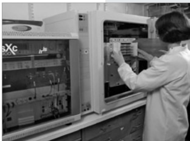
Abbildung 7: Zellproben werden in das sXc-900-Expositionssystem geladen.
